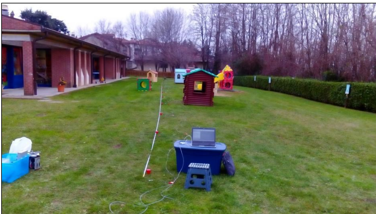
Figura 15 - Sito 3, prova MASW
