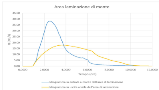
FIGURA 43- LAMINAZIONE DELL'EVENTO CENTENARIO INDOTTA DALL'AREA DI ESPANSIONE A MONTE.
