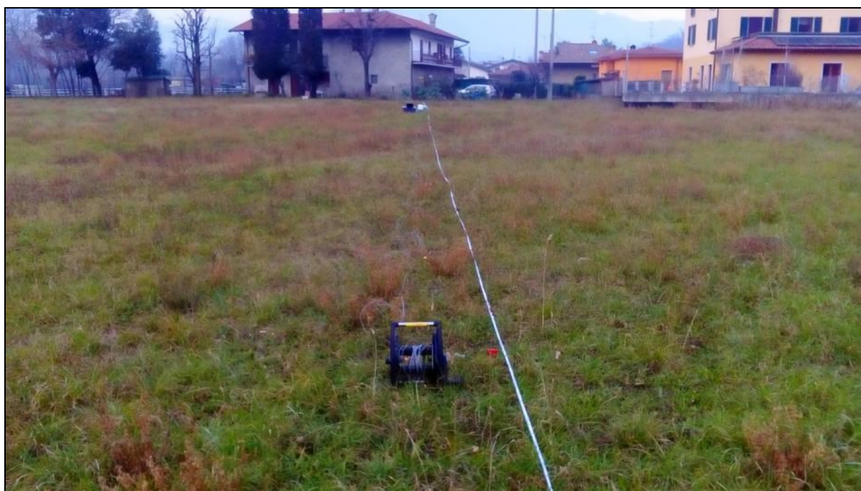
Figura 18 - Sito 4, prova MASW
