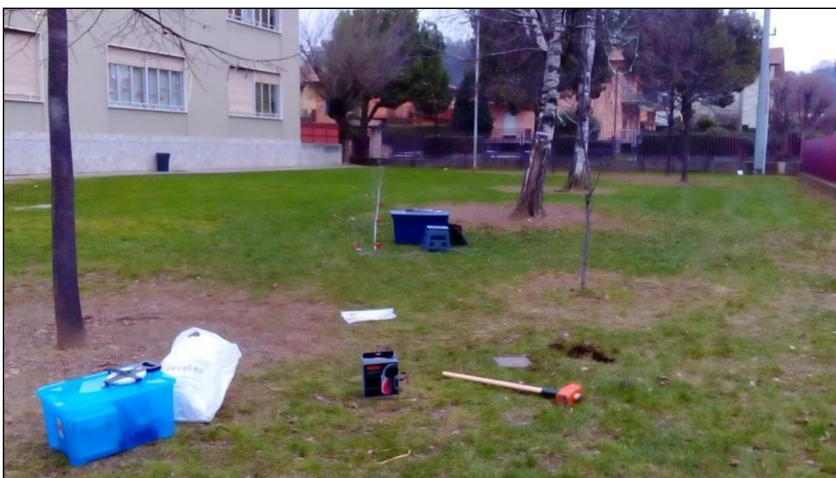
Figura 12 - Sito 2, prova MASW
