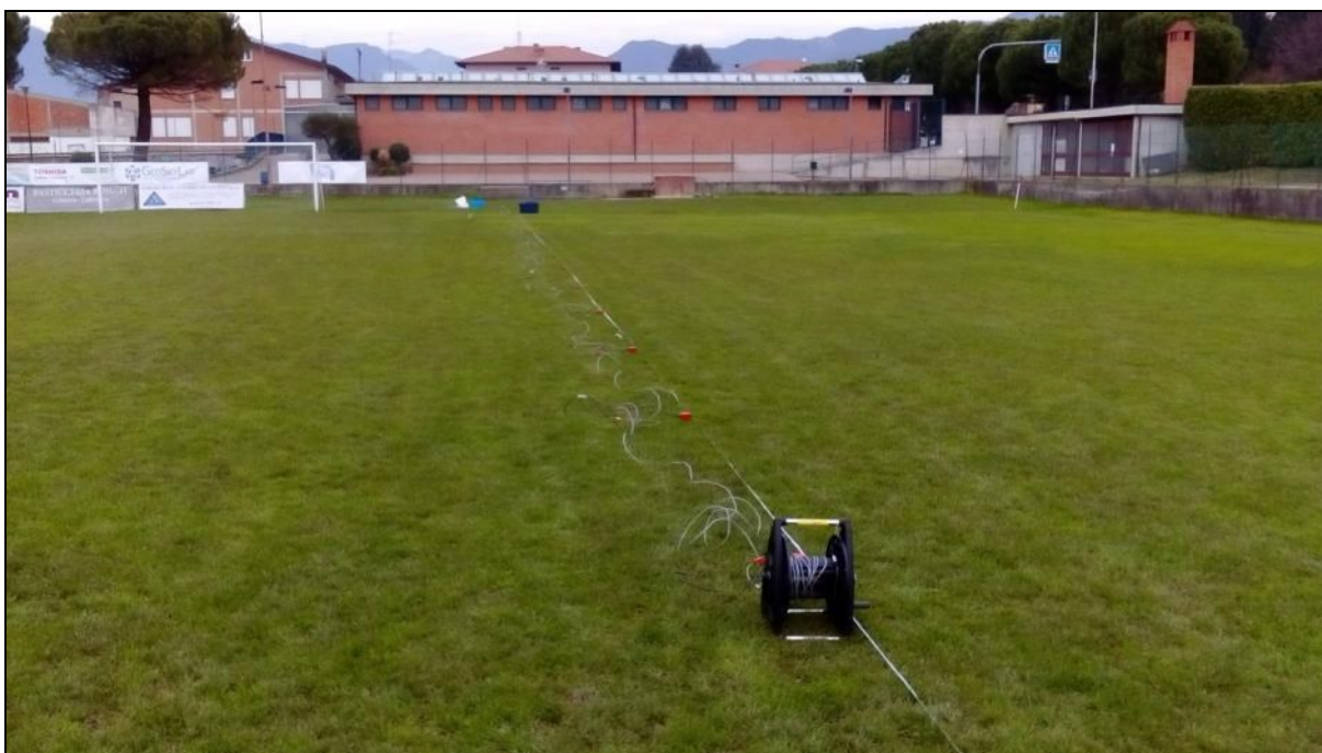
Figura 9 - Sito 1, prova MASW
